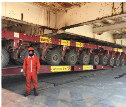
Maniobra de carga y arrastre con carritos o strand jack
